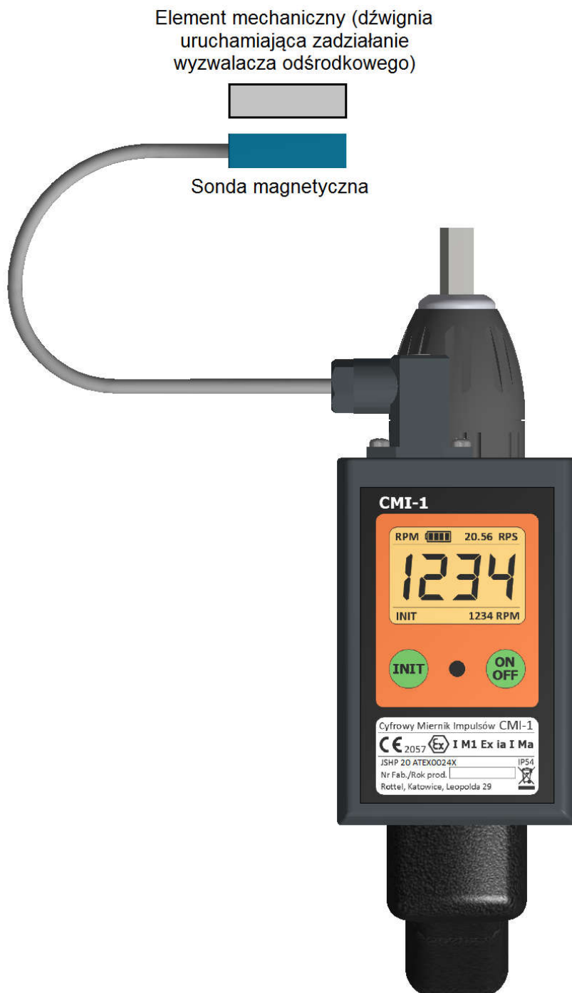
Rys. nr 2. Cyfrowy miernik obrotów CMO-1 – usytuowanie sondy magnetycznej względem wyzwalającego elementu mechanicznego
